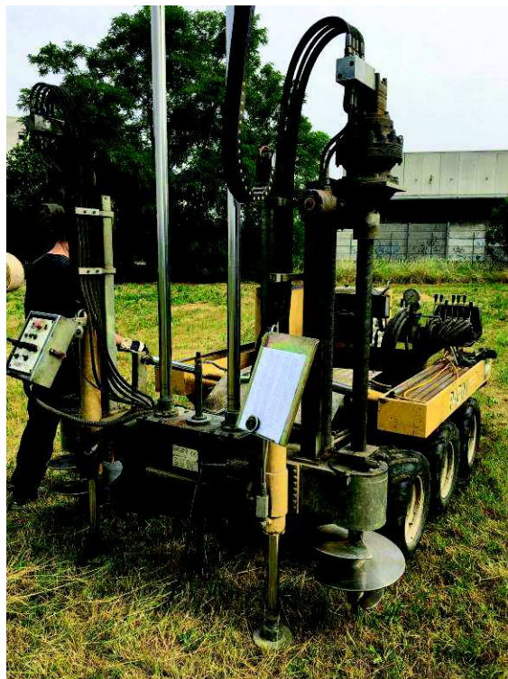
Esecuzione delle prove penetrometriche.
