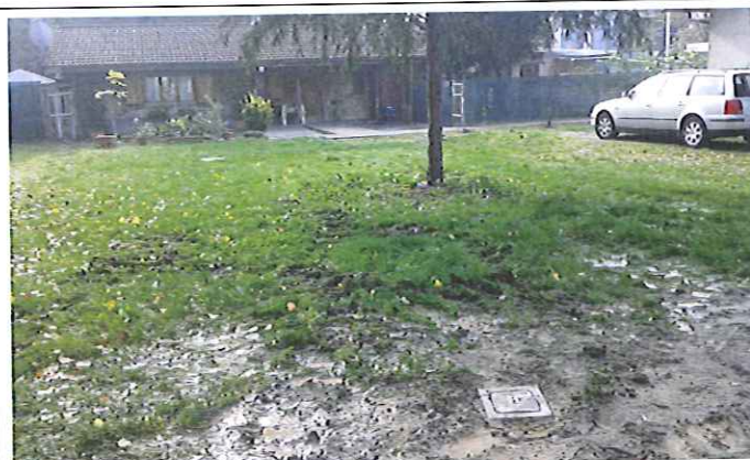
Foto 12: la testa del piezometro è protetta in superficie da apposita cameretta in calcestruzzo chiusa da coperchio a raso
