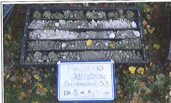
Foto 7: cassetta catalogatrice contenente i successivi 5 metri di carota di terreno del sondaggio S3 (da -5 m a -10 m da p.c.), suddivisa in 5 spezzoni ognuno della lunghezza di un metro. Per la descrizione dei sedimenti si rimanda alla stratigrafia riportata in allegato 4
