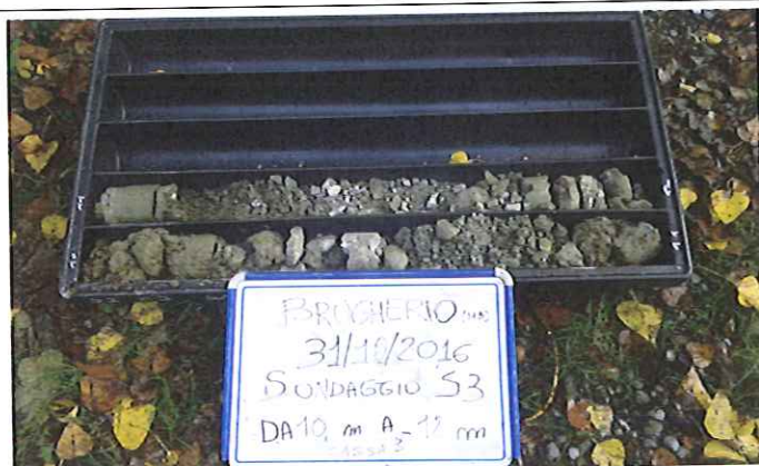
Foto 8: cassetta catalogatrice contenente i rimanenti 2 metri di carota di terreno del sondaggio S3 (da -10 m a -12 m da p.c.), suddivisa in 2 spezzoni ognuno della lunghezza di un metro. Per la descrizione dei sedimenti si rimanda alla stratigrafia riportata in all. 4
