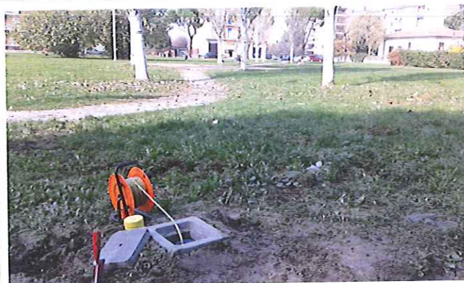
Foto 14: lettura del livello idrico statico presente all'interno della colonna del piezometro mediante sonda freaticometrica; la testa del piezometro è protetta da pozzetto in calcestruzzo a raso
