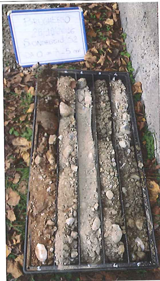
Foto 4: cassetta catalogatrice contenente i primi 5 metri di carota di terreno del sondaggio S2 (da p.c. sino a -5 m di profondità), suddivisa in 5 spezzoni ognuno della lunghezza di un metro. Per la descrizione dei sedimenti si rimanda alla stratigrafia riportata in allegato 4
