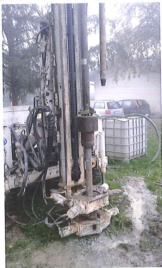
Foto 9: esecuzione prova SPT (maglio ancorato in attesa di sollevamento)
