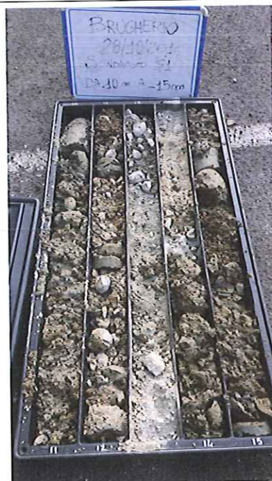
Foto 10: cassetta catalogatrice contenente i rimanenti 5 metri di carota di terreno del sondaggio S1 (da -10 m a -15 m da p.c.), suddivisa in 5 spezzoni ognuno della lunghezza di un metro. Per la descrizione dei sedimenti si rimanda alla stratigrafia riportata in all. 4
