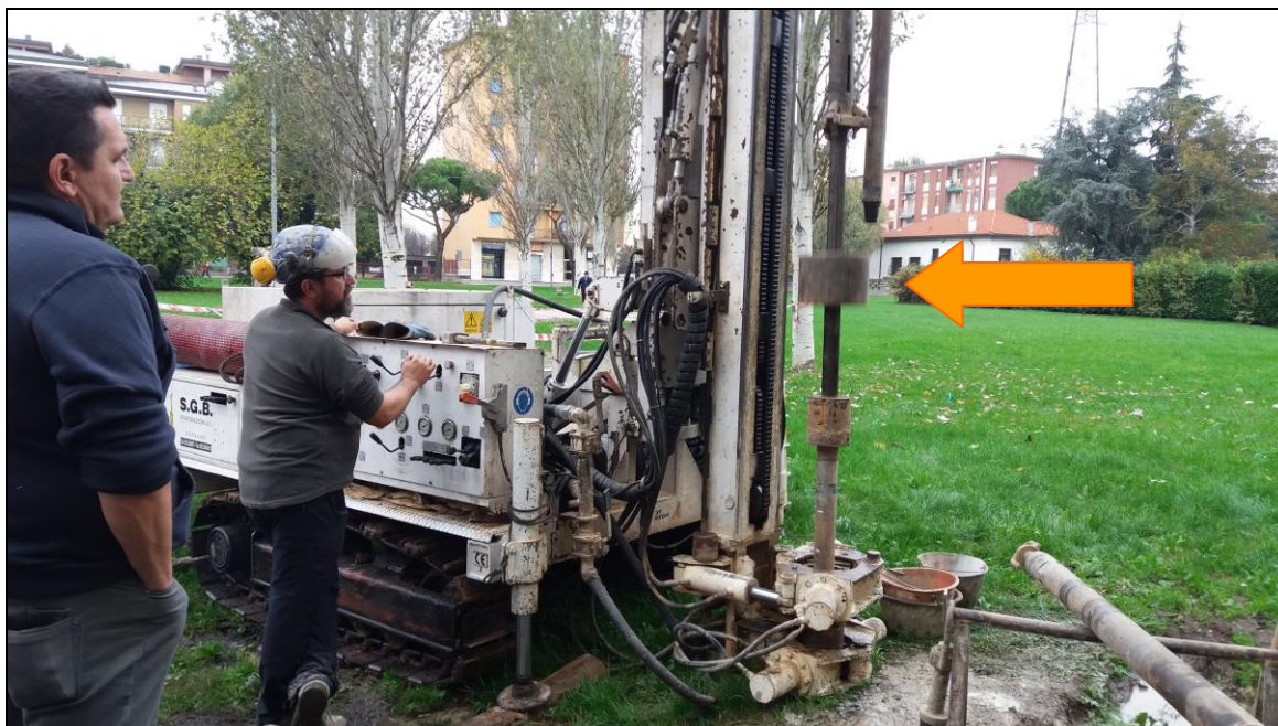
Fig. 14: esecuzione prova penetrometrica dinamica in foro (SPT). La freccia indica il maglio in caduta
