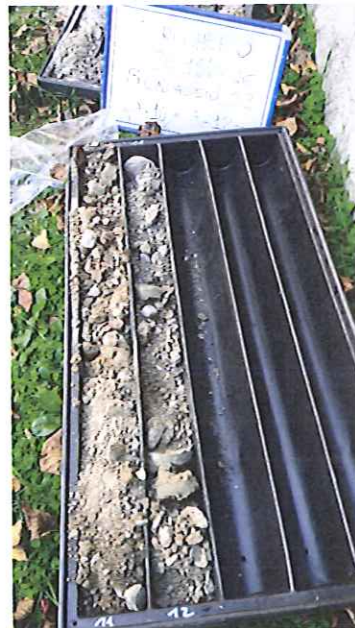
Foto 6: cassetta catalogatrice contenente i rimanenti 2 metri di carota di terreno del sondaggio S2 (da -10 m a -12 m da p.c.), suddivisa in 2 spezzoni ognuno della lunghezza di un metro. Per la descrizione dei sedimenti si rimanda alla stratigrafia riportata in all. 4
