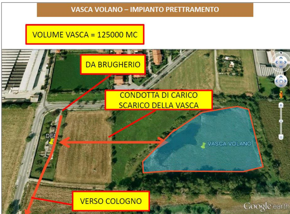
Figg.47-48 Rapporti tra rete e vasca volano e schema funzionamento a gravità della stessa (da documenti CAP)
